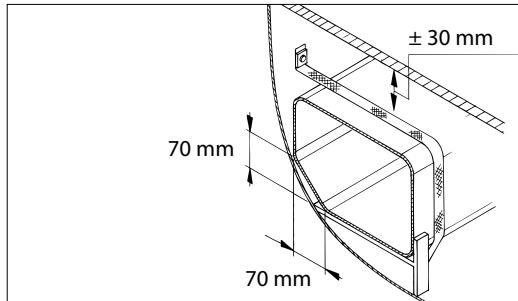
Das Fundament, auf dem der Tank befestigt wird, muss ausreichend stabil sein. Berücksichtigen Sie bei der Befestigung des Tanks, dass seine Maße geringfügig größer sind, wenn er gefüllt ist.
