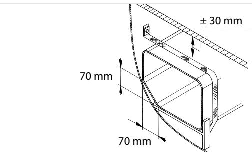
Veiller à disposer d'une base suffisamment stable pour pouvoir installer et fixer solidement le réservoir. **Les dimensions du réservoir augmentent légèrement lorsque celui-ci est plein.** En tenir compte lors de la fixation du réservoir.
