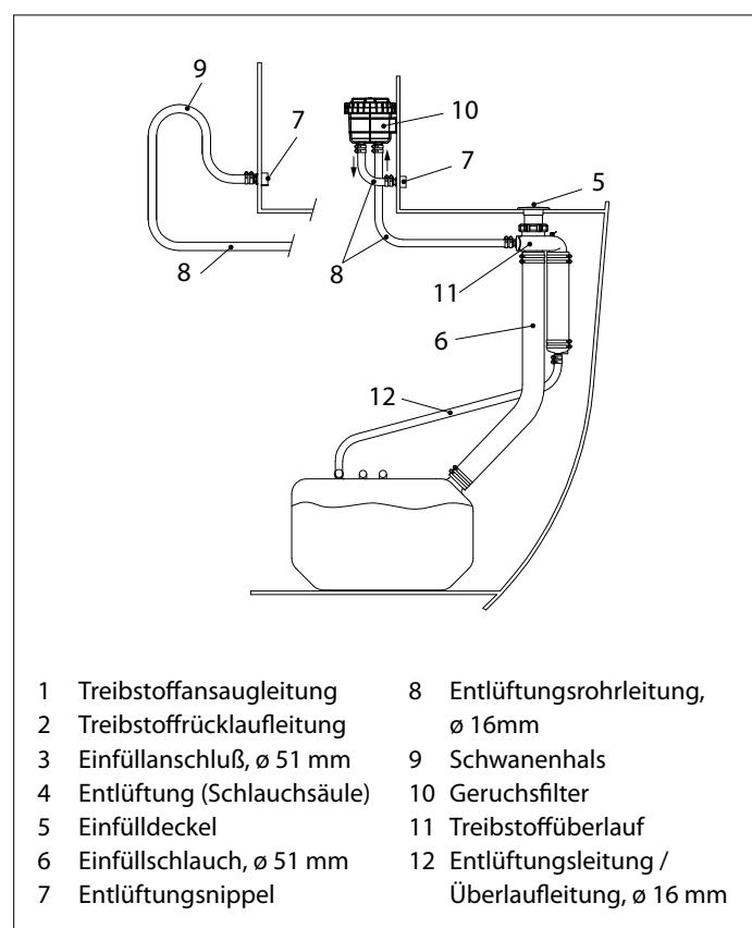
1 Treibstoffansaugleitung      8 Entlüftungsrohrleitung, ø 16mm
